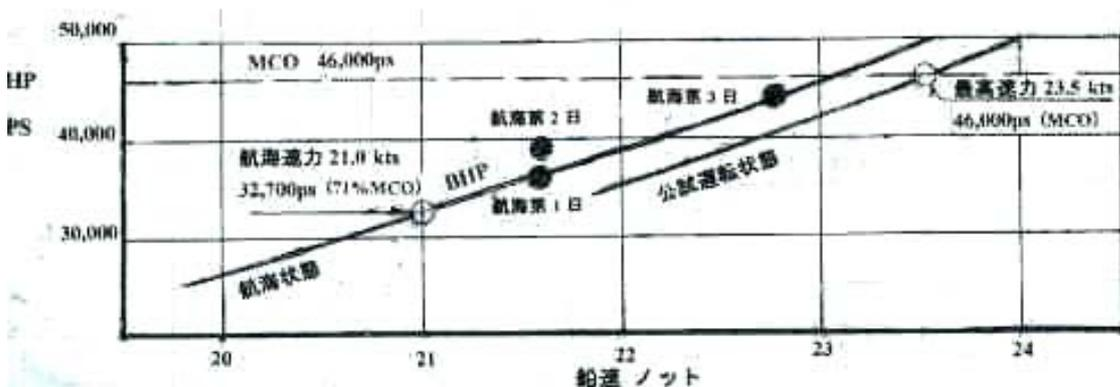
Fig. 2 タイタニック号 速力-馬力推定
