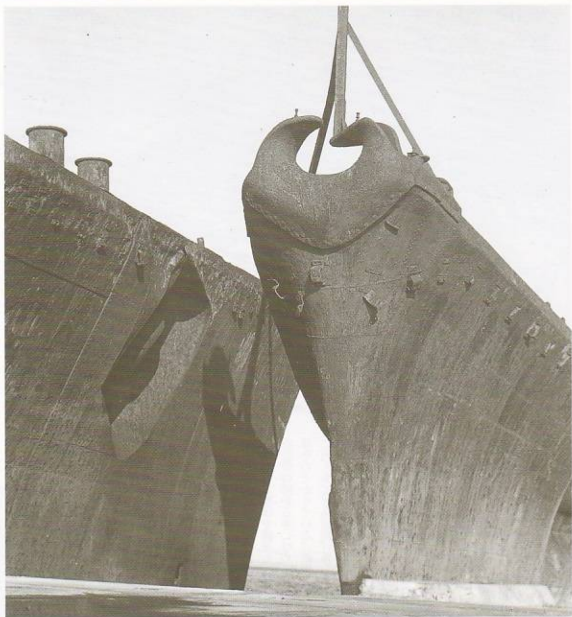
左が「涼月」。右の「冬月」は鉄物製のフェアリーダーの形状がよく判る。艦首旗竿は主柱も支柱も板材のように見える（撮影＝朝長浩）。
