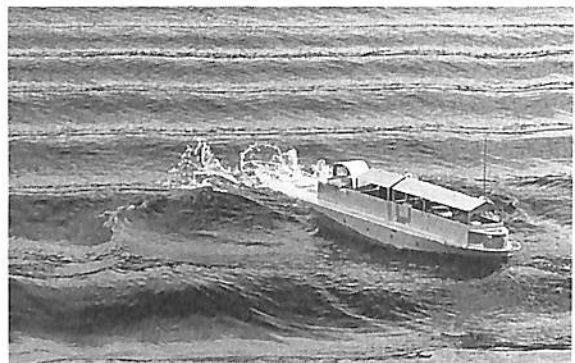
SR131 波浪外力に関する水槽試験 鉱石運搬船（笠木山丸）波浪変動圧の測定
