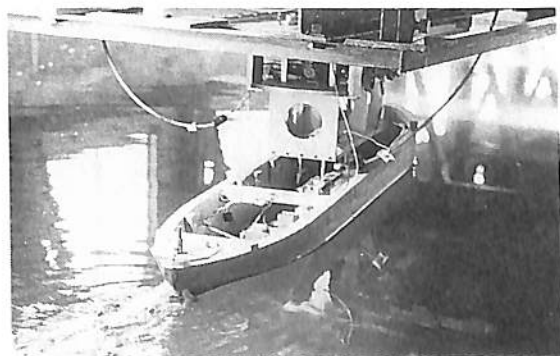
SR98 巨大船の運航に関する研究 タンカー船型による斜航試験 (東京丸1.5 m 模型)
