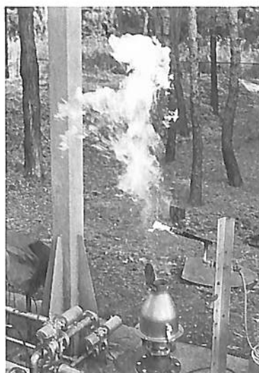
RR73 高速排気管頭の連続燃焼試験 (カーゴタンクへの火炎侵入防止装置)
