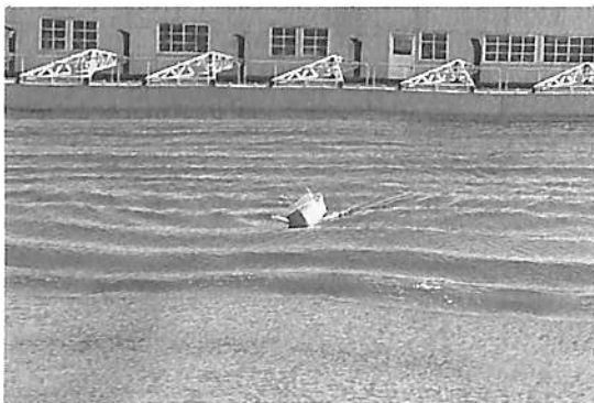
RR17 模型船の斜追波中の転覆実験
