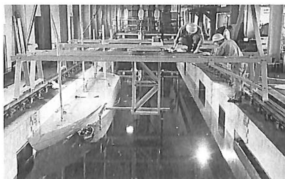
SRD13 新救命艇の進水、離脱に関する水槽試験
