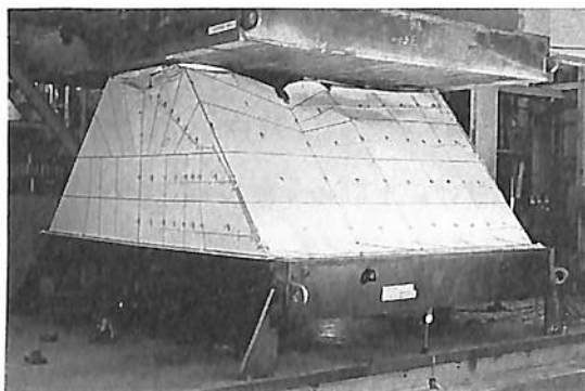
NSR10 原子力船の耐衝突構造の評価に関する試験研究（タンカー船首模型崩壊実験）
