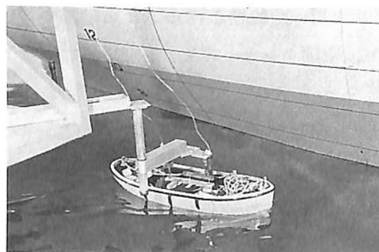
SRD13 新救命艇の進水、離脱に関する水槽試験
