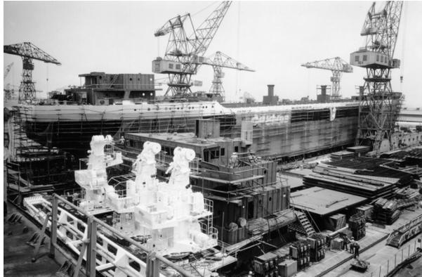
写真 6 進水直前・手前は搭載準備中の上部構造の総組とデッキクレーン
