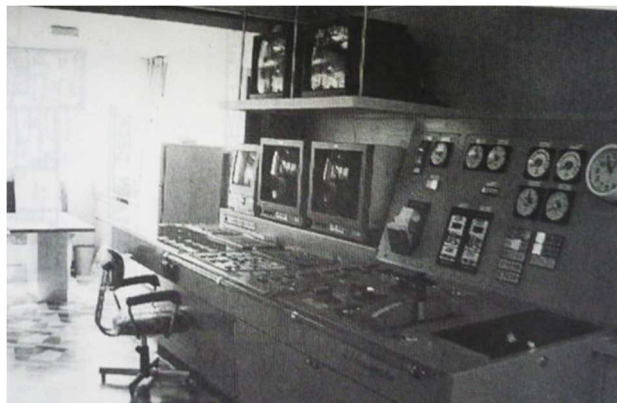
23) W69 - 23 鶴洋丸 船橋主機操縦台
