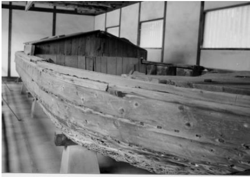
川ひらた [芦屋町教育委員会；長さ13.3m、幅2.7m、深さ0.6m；現在飯塚市川船研究会が、これをモデルに復元を計画]
