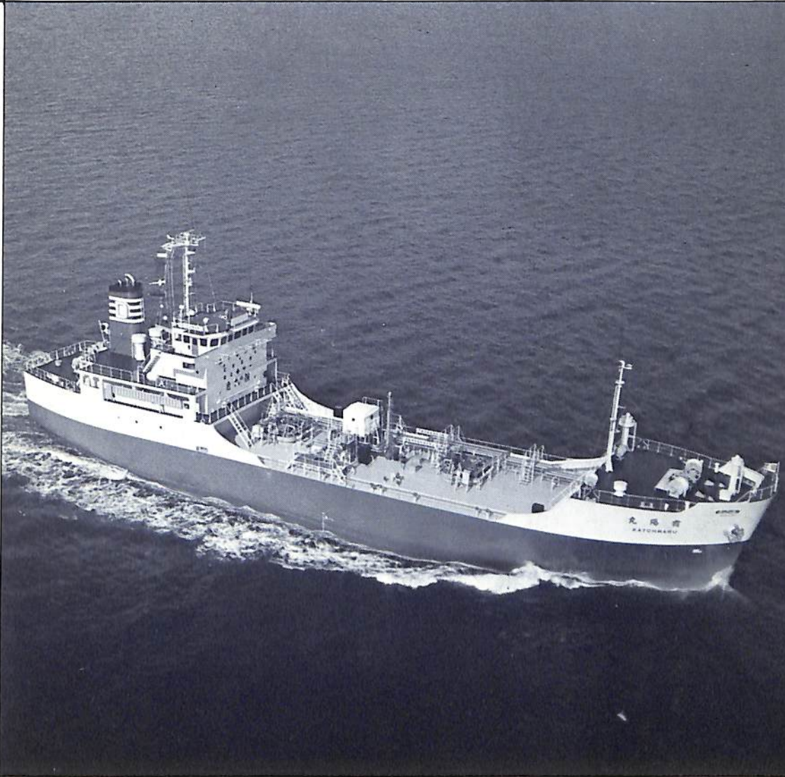
第一マリン株式会社向け/自立角型ガス・キャリアー“震陽丸”
