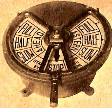
指針及文字盤は合成樹脂製で、内部照明調節により、明瞭に視認出来るようになってゐる。發信器と受信器と受信器側にベルが附屬してゐる。
