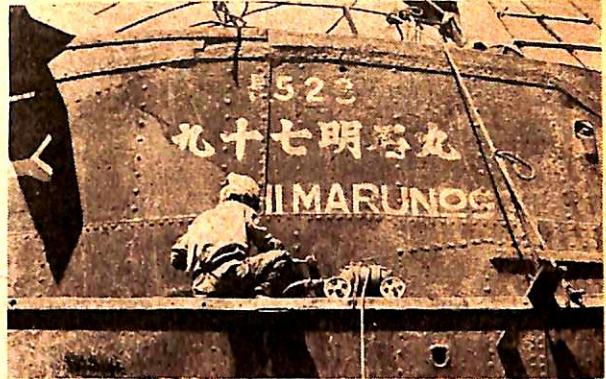
船尾外板で作業中、錆落とし部分のはつきり分る
