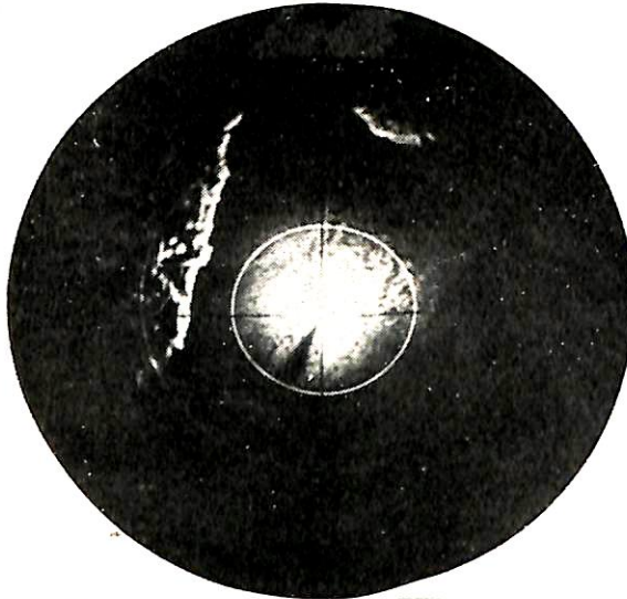
第9図 FTCとSTCで雨の反射を消した所 左図(イ) 右図(ロ)
