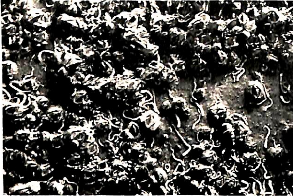
写真1 船底の附着物で最も手ごわいフヂツボとセルプ ラの群落 (実物の1/2大)
