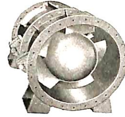
(10HP軸流型電動送風機)
