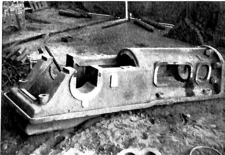
第 3 圖 三菱化成御注文 2,000HP ガスコンプレッサーフレーム 重量 7,200kg 抗張力 32.8kg/mm 2 横折荷重 2,090kg 撓み 4.2mm (JIS 規格)
