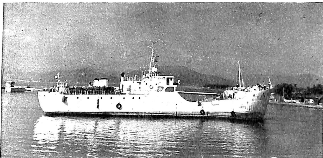
高速多気筒冷凍機を装備した 大富士丸 (静岡県水産指導船)
