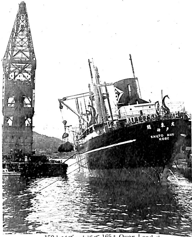
150トンブームにて165t Over Loadを 振出した際の船体傾斜を示す
