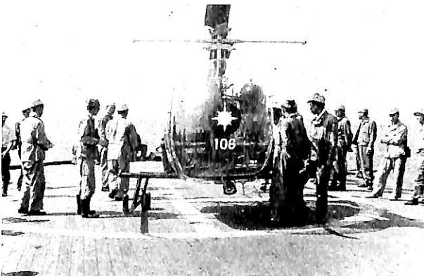
船尾のヘリコプター発着甲板と搭載ヘリコプター（ベル47G型）
