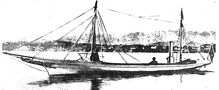
MIGNON 世界で初めて建造された軽合金船で1891~92年にチューリッヒのWyss & Co.で竣工した
