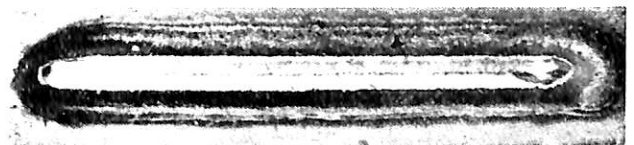
第3図 MIG熔接における黒粉の発生（ANP, 1.6mmワイヤ, 200A, 25V, 20in/min)×1/2
