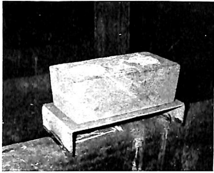
油槽船船槽に取付けられた 電気防蝕用Mg陽極(60-S)
