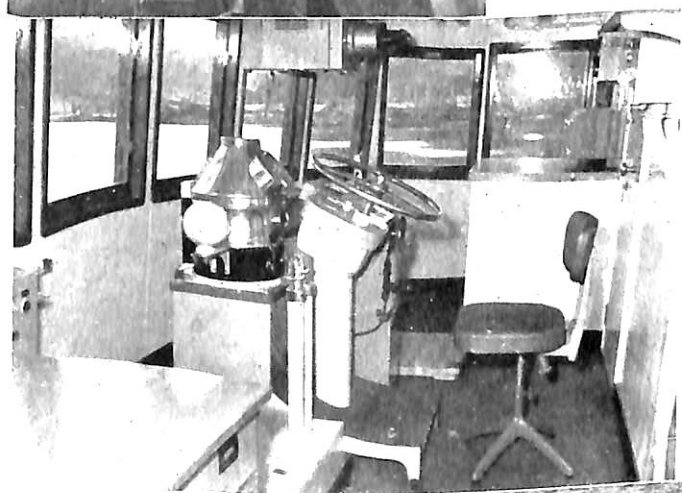
第二播磨丸の船橋操舵室 中央磁気コンパスの前にコントロール・スタンド がある。手前は海図台、右舷側にレーダーが装備 された。
