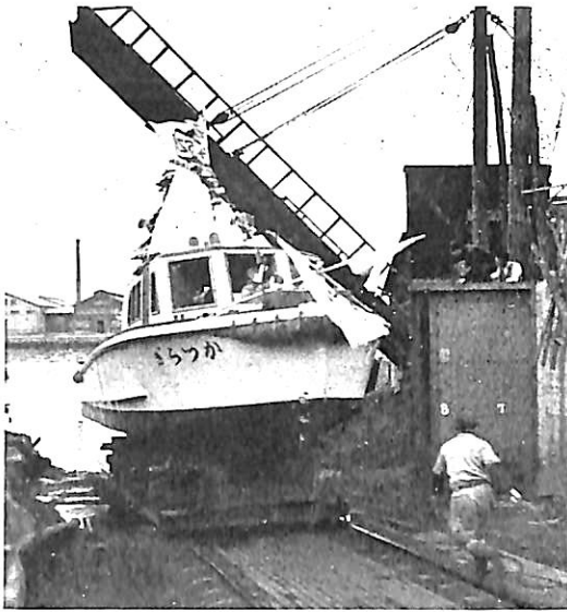
↑ 12m型監視艇 かつらぎ 大阪税関 株式会社信貴造船所 建造 起工 32-12-11 進水 33-2-18 全長 12.00m 型幅 3.30m 型深 1.50m 平均吃水 0.550m 総噸数 約14T 排水量 8.5Kt 主機械 GM6071A ディーゼル機関 1基 出力(定格) 235BHP 速力(最大) 16Kn
