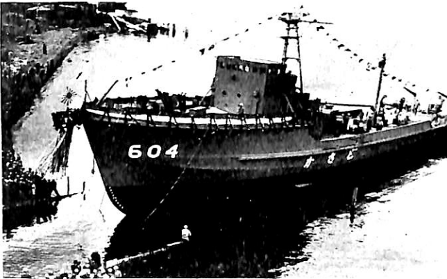
← 中型掃海艇 かさと 防衛庁 日立造船株式会社神奈川工場建造 起工 32-7-9 進水 33-3-19 竣工 33-6-30予定 長さ 約45.00m 幅 約8.40m 深さ 約3.85m 吃水 約2.35m 基準排水量 約350Kt 主機械 三菱横浜製 YV10Z型ディーゼル機関 2基 出力(計画 全力)600BHP×2 速力(最大)約13.5Kn 兵 装 掃海具一式 20mm単装機銃1門 高周波 接着積層材使用、高速艇構造方式による木製
