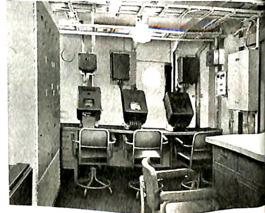
測量室内(左舷) 音響測深儀指示器
