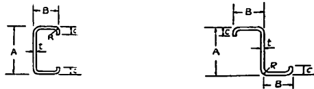
第1表 軽量形鋼の形状、寸法、重量および定尺 (註) 販売の場合は JISG 3192の重量計算法による
