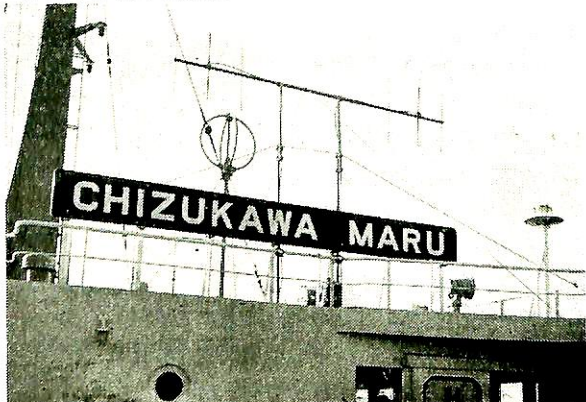
第3図 計測局空中線 (計測中の送信用空中線を示す)
