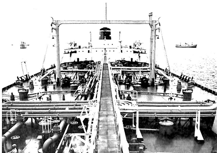
中部上甲板上の荷油配管と通路
