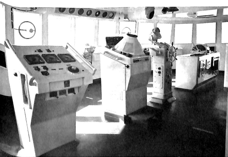
操舵室内主機操縦スタンド
