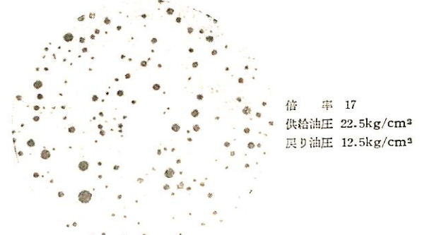
第3図 リターンフロー形バーナによる原油の噴霧粒径
