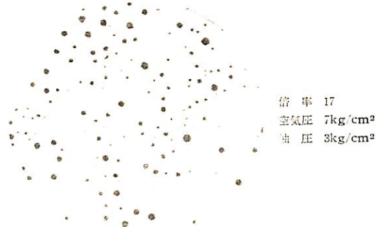
第2図 空気噴霧式Yジェット型バーナによる原油の噴霧粒径
