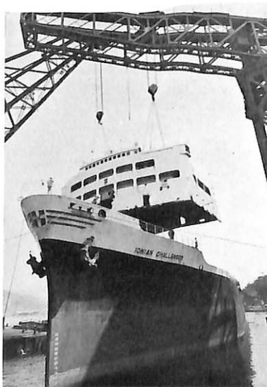
旧船首部より船橋取外し
