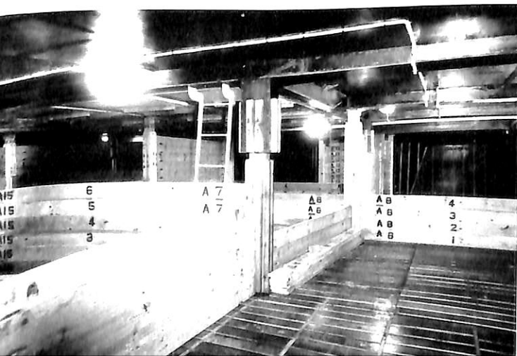
◀ 吹上げ方式を採用した冷蔵貨物艙
