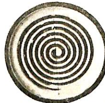
写真 5 低圧渦巻状丸型ストリップヒーター (850~900°C, 上温速度 1 分間)
