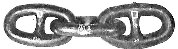
103mmφ, 835 t (破断荷重×110%) 試験後
