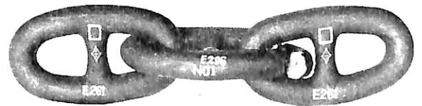
76mmφ, 568 t 破断試験後
