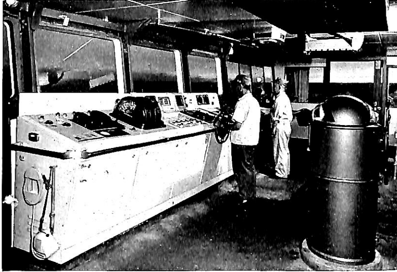
操舵室内のブリッジ・コンソールによる操舵
