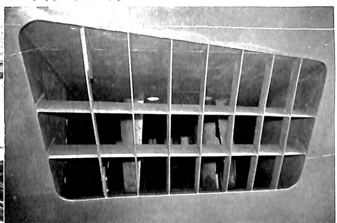
バウスラスター・トンネル (外舷よりみる)
