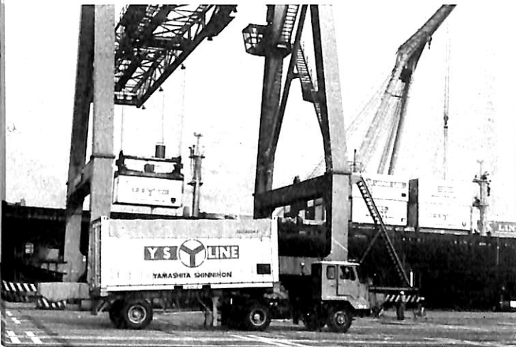
コンテナ・ターミナル岸壁クレーンによるコンテナ搭載
