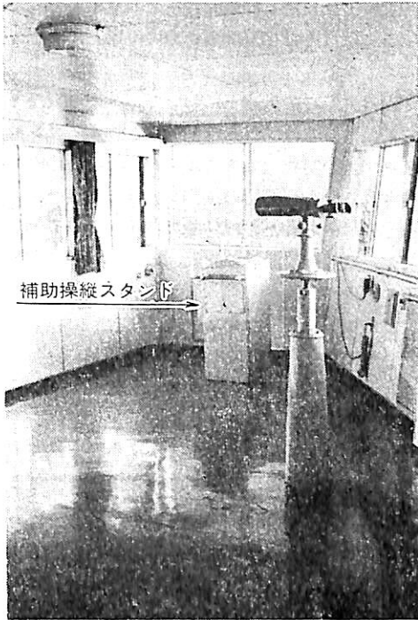
写真 4-16 左舷舷側部に設けられた補助操縦スタンド (十和田丸) (国鉄船舶局古川達郎氏撮影)
