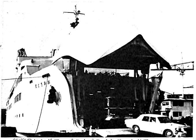
船首のヒンジアップタイプのパウポードア
