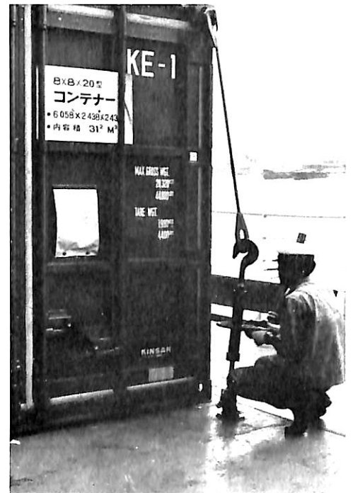
甲板積みコンテナのラッシング
