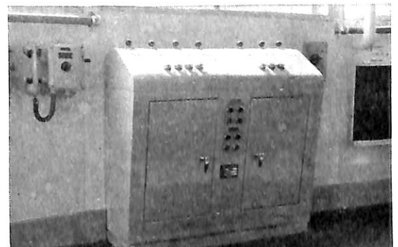
写真 10-8 操舵室用操縦スタンド(ウインドラス用)
