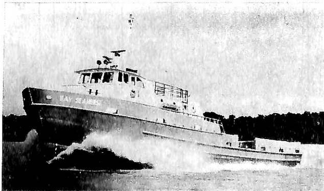
写真3 アメリカの全アルミ合金製 Crew & Supply Boat (全長110尺)
