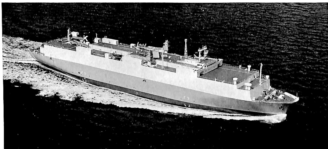
4,700台積自動車専用船 速力22.3kn "AMERICAN HIGHWAY"
