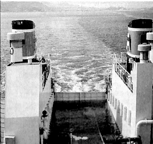
船橋よりスリップ ウエイを見る "きさん2号"を格納する。試運転時で、まだ移動クレーンは装着されていない。
