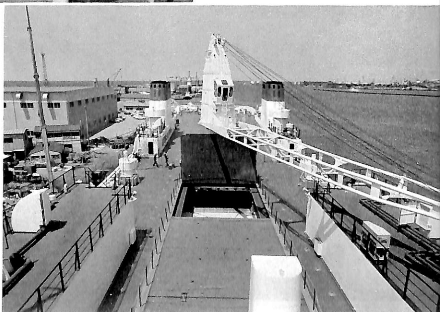
上甲板 大型車を搭載する他、中央部のデッキクレーン（5t）を使用し、中央部ハッチより主甲板及び艙内に一般貨物も搭載出来る。 （船橋より船尾方向を見る）
