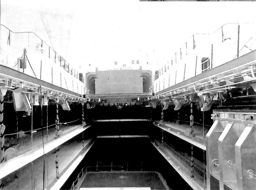
上甲板 大型車を搭載する他、中央部のデッキクレーン（5t）を使用し、中央部ハッチより主甲板及び艙内に一般貨物も搭載出来る。 （船橋より船尾方向を見る）
