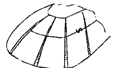
図3-c 艀龍皮板の突合せ溶接
