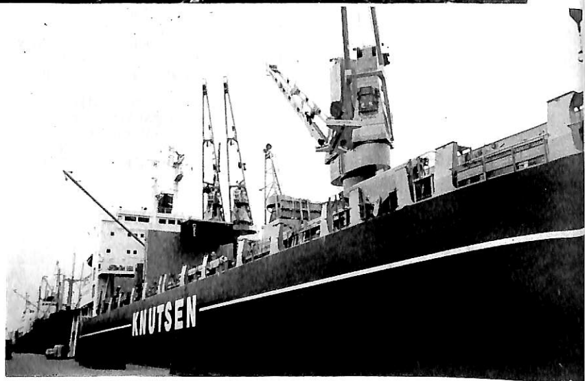
▲ 荷役中 25t ツインクレーン (中央) と 16t ツインクレーン (左方)
