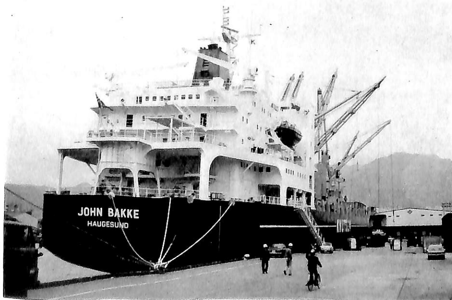
船尾部 船尾甲板上中央はプール (5m×3.5m×2m 深さ) で、航海甲板後方横に 10t デリック ブームが左右についている
