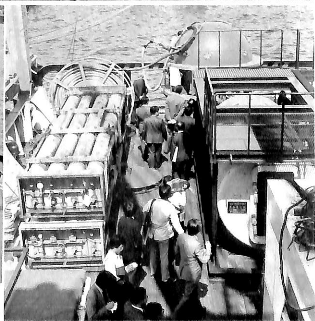
船尾作業甲板(左写真)と SDC, DDC システム搭載状態 ▶ 船尾に SDC, 右方に DDC 及びコントロール室 左方に高圧ガスバンクがある。
