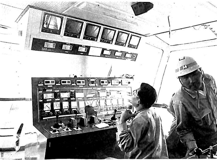
アンカー ウインチ コントロール室 アンカーワイヤのウインチドラム 巻込みを ITV にて監視中 中央はウインチ操作盤
