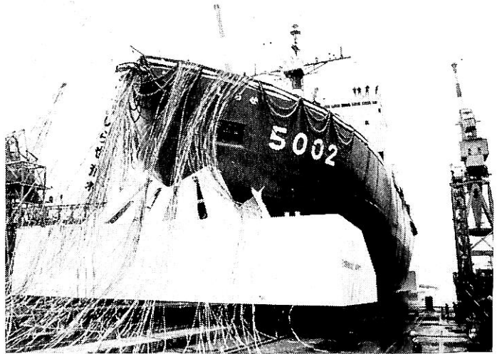
進水する“しらせ” 船首下方に見えるのはフロート(浮力タンク)で進水の際船底部を海底面に付けないためのもので、同様のものは船首部にも付いている。
