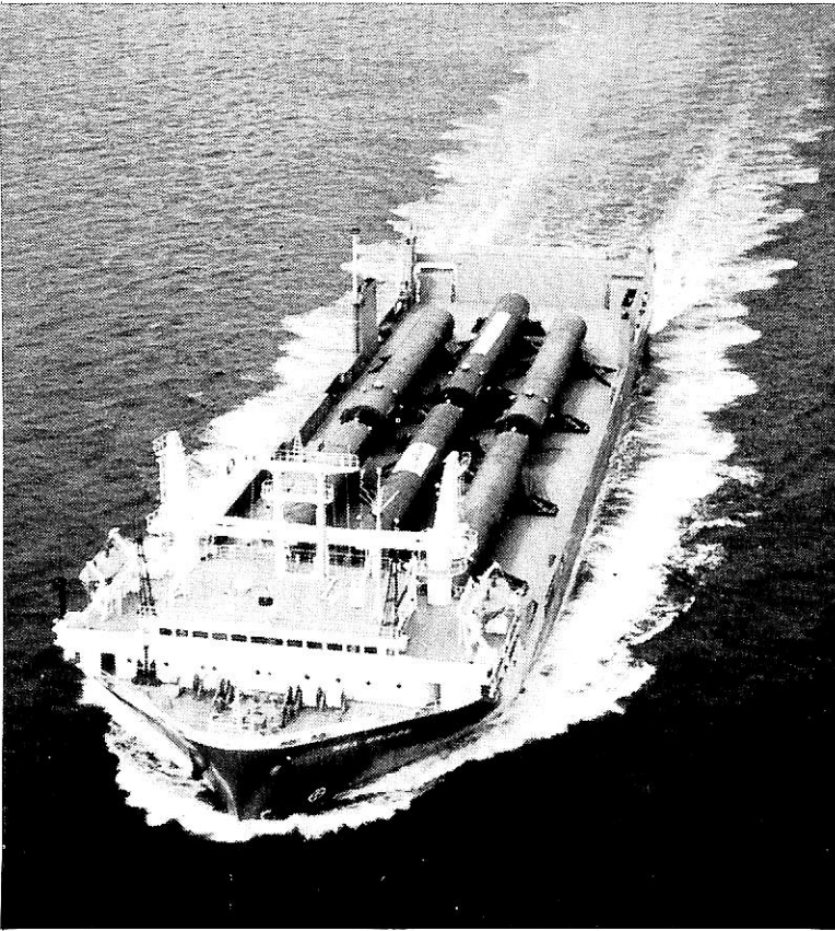
“SEA BRIDGE” 米国向け圧力容器を搭載しての処女航海 （単体は約1,200 t）（運航は日之出汽船（株））
