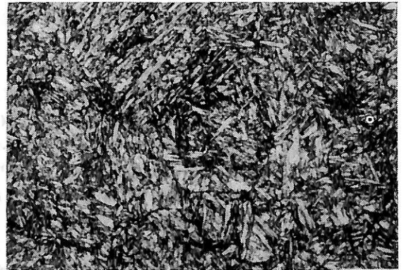
写真1 10Ni-8Co 鋼の用材顕微鏡写真 (X400)
