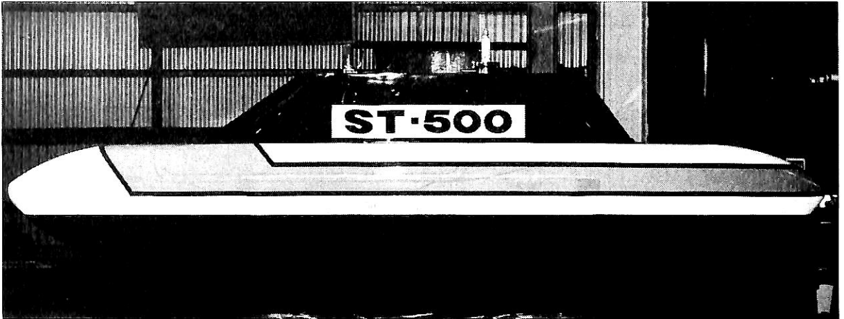
図3 世界初の本格的な超電導電磁推進モデル船 12)
