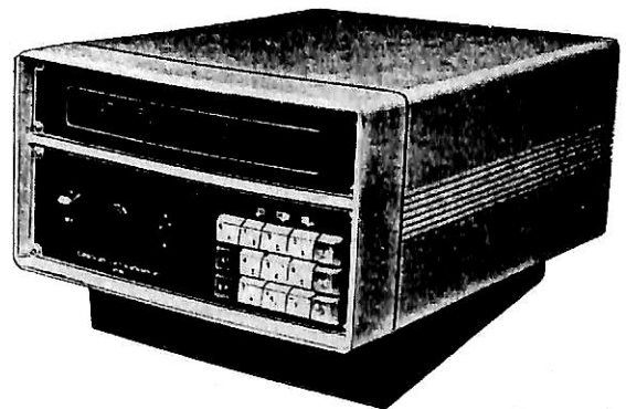
第A・4・10図 デッカ座標変換プロセッサ DP-80型 (外形寸法は 270×330×212 (mm))
