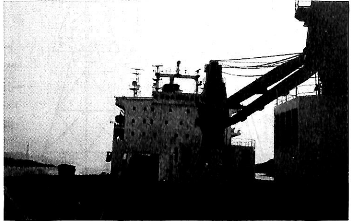
甲板上の40t シングルクレーン（2基：組合せると最大80t 吊り可能）
