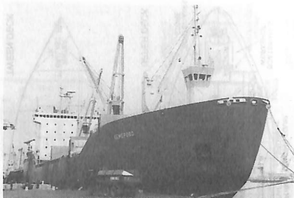
船首部 (見張り塔, クレーン, ブリッジが見える)
