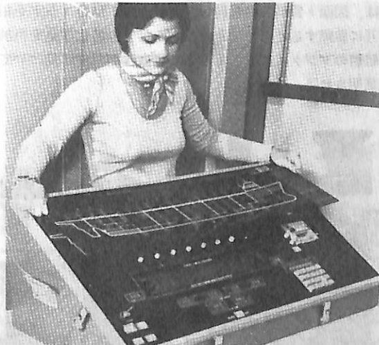
写真1 積付け計算機は、ケミカルタンカーにとって重要な助けとなる。LRは、USA Raytheon 製ロードマックス計算機を検査する。この高度な機器は、どのような積付け状態でも喫水、復原性および応力のデータを計算する。
