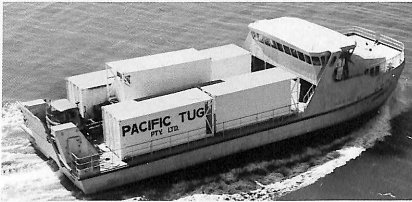
豪州ノースクイーンズランドで就航しているカタマラン型フェリー Glen Class (全長 25m) "KANIMBIL" 船上はトラック及びコンテナ
