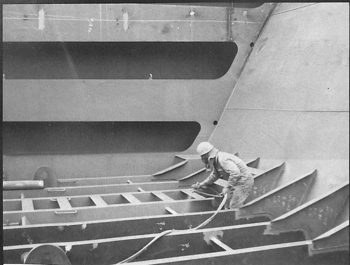
バラストタンク兼用ホールド(F.D.A) 吹付塗装
