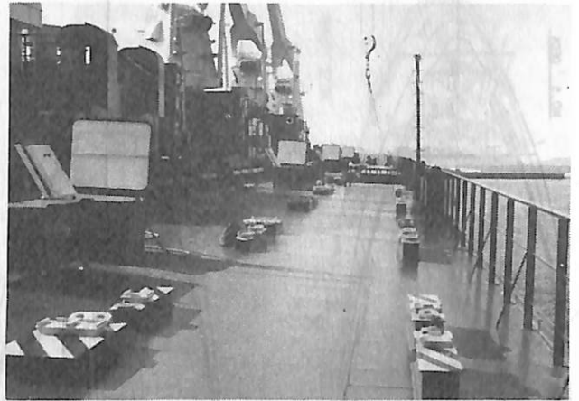
長船首楼甲板上的コンテナ搭載金物
