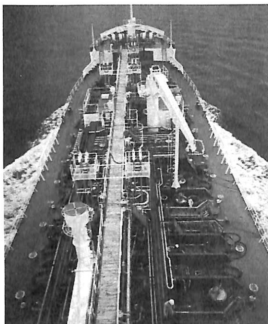
ブリッジより船首方向をみる、上甲板の複雑なパイピングがわかる。中央はフライングパッセージ
